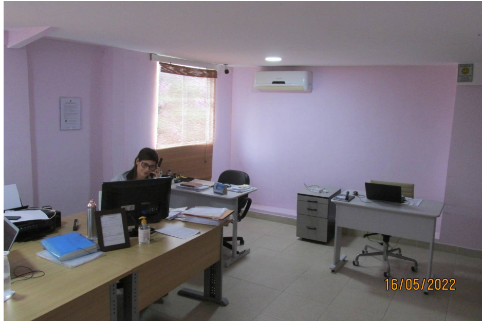
Foto 48) Vista da sala existente após a dependência anterior e confrontante com a Travessa Canoas. Observar piso em porcelanato, rodapé como o piso, paredes e teto, em forro de gesso, a látex sobre massa corrida.
